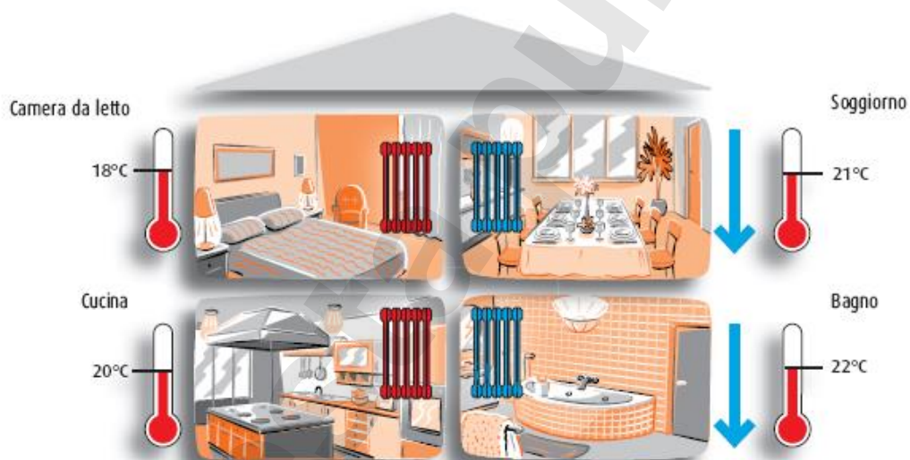
Figura 26 – Termoregolazione a zone: permette di ottenere la temperatura ottimale per ciascun ambiente
