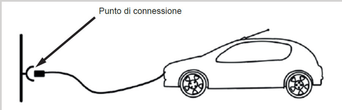
Figura 3 – Punto di connessione costituito da un connettore mobile per il veicolo che è parte di un EVSE installato in modo fisso
