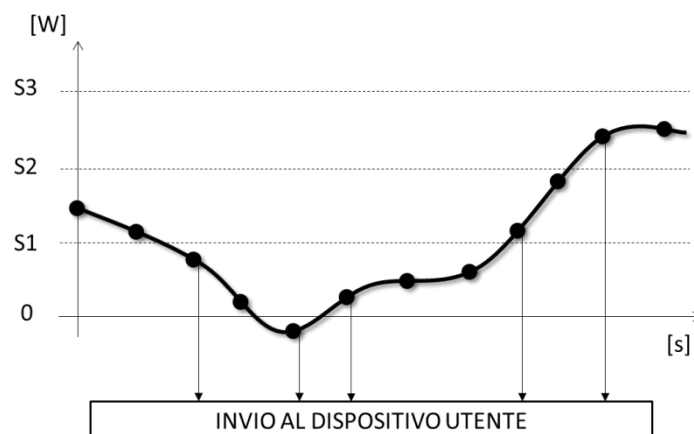
Figura X2– Logica di invio del campione di potenza attiva istantanea registrato dal misuratore intelligente 2G ogni secondo per mezzo del sistema Chain 2 ad attraversamento di soglie predefinite
