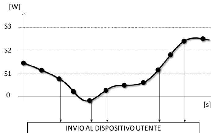
Figura 97 Figura X2– Logica di invio del campione di potenza attiva istantanea registrato dal misuratore intelligente 2G ogni secondo per mezzo del sistema chain 2 ad attraversamento di soglie predefinite
